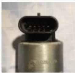
AGR Ventil für alle Fahrzeuge mit Opel Z22SE Motor (2.2i 16V, 108 kw / 147 PS)
